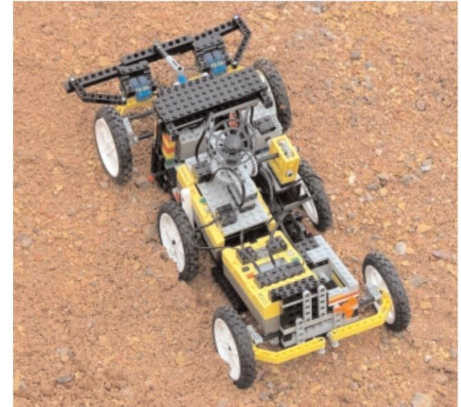
A csapat robotspecialistája pedig egy legóból épített járművet tesztelt a marsi terepen, amelyet a robotépítő szakkör tagjai készítettek erre a célra. A hat kerekű, programozható szerkezet a NASA *Mars Exploration Rover* jeihez hasonlóan képes arra, hogy automatikusan kikerülje az útjába kerülő akadályokat, így egy későbbi változata talán a Marson is sikerrel járhat majd.
